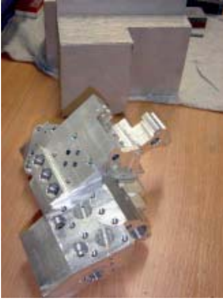
Ventilblöcke für die Luftfahrtindustrie sind sicherheitskritische Hydraulikaggregate, bei denen bis zu 1500 Prüfmerkmale anfallen
