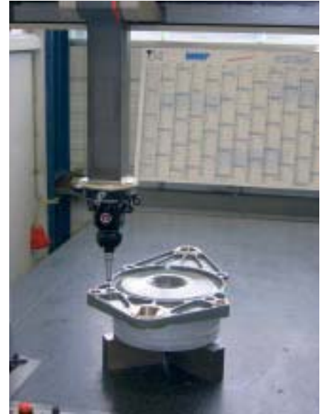
Bei vielen Teilen ist eine 100 Prozent-Prüfung obligatorisch
