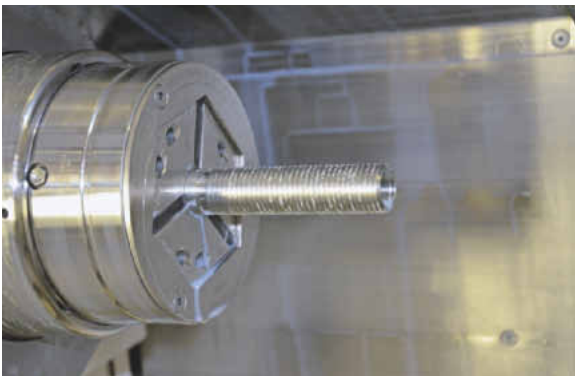
Auf der neuen Hyper-Quadrex werden diese Dämpferbauteile in hohen Losgrößen gefertigt
