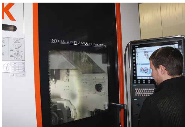
Mit 37 kW und einem maximalen Drehmoment von 152 Nm bei einer maximalen Drehzahl von 18.000 Umdrehungen können deutlich bessere Zerspanungswerte erreicht werden.
