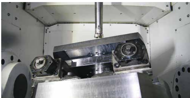
Dank des in die Schwenkbrücke integrierten NC-Rundtisches kann das Teil in nur einer Aufspannung komplett bearbeitet werden.
