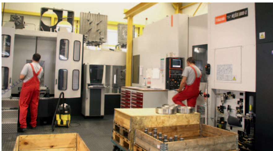
3 Lläuft wie ein Uhrwerk: Der Einstieg in die Horizontalbearbeitung in Kombination mit dem modular ausbaufähigen Palletech-System hat sich für ZTM ausbezahlt. An der Be- und Entladestation links werden die Platten hauptzeitparallel ein- und ausgeschleust
